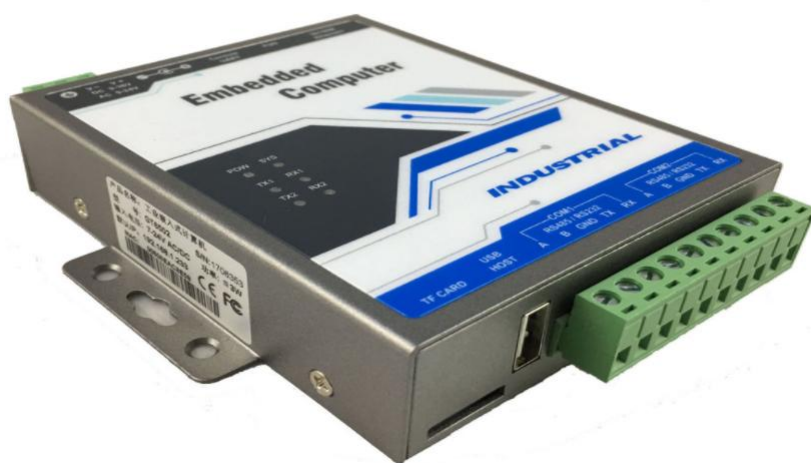
图 1-2 GT6757 嵌入式 ARM 硬件平台实物照片
